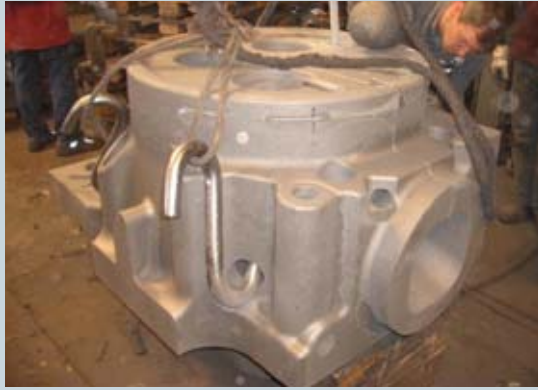
Bild 5: Rohgussteil nach der Strahlbehandlung Stückgewicht 2100 kg (generativer Formenbau)
