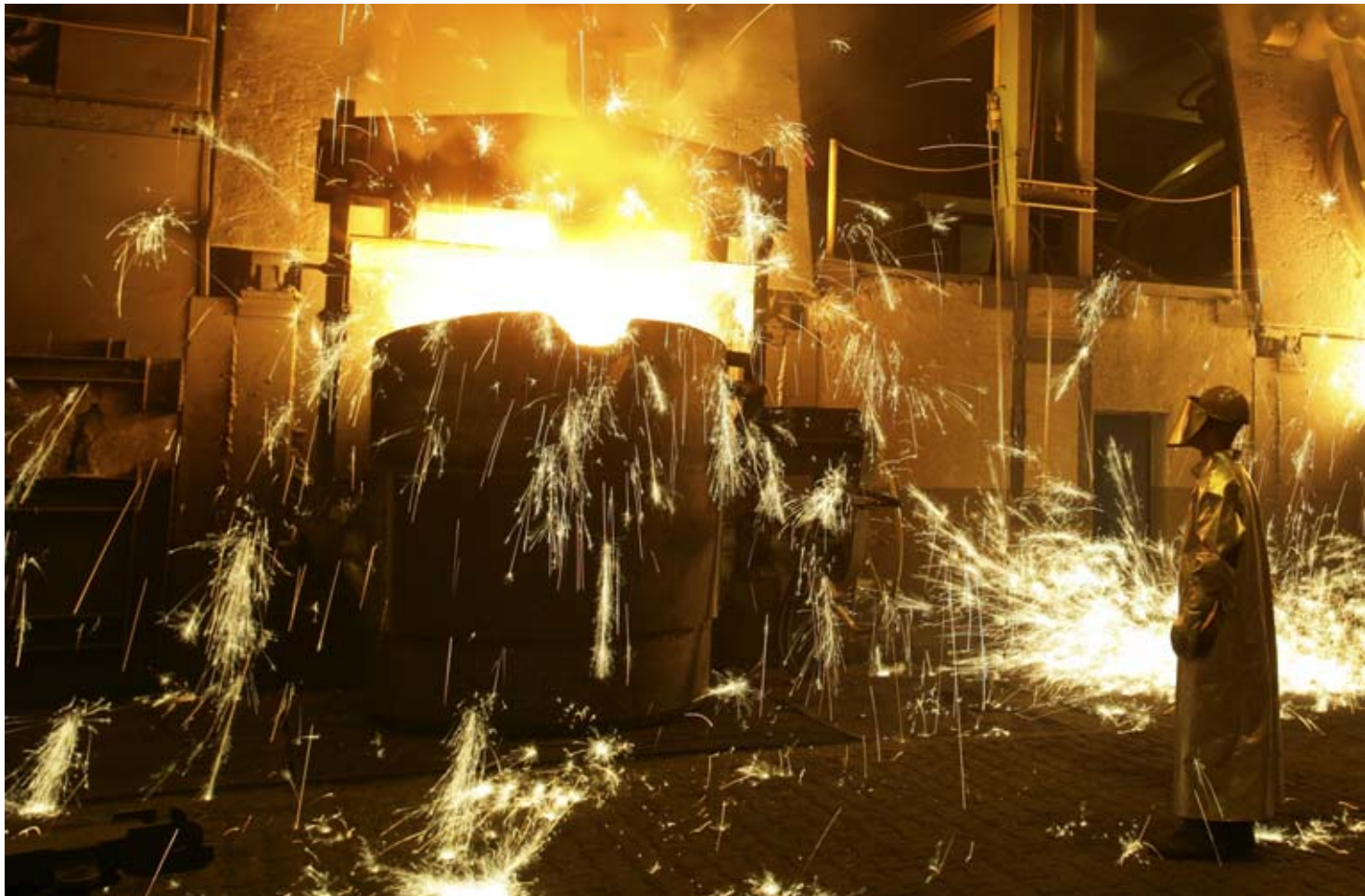
In der Augsburger Gießerei hergestellt: Große Gussteile aus Gusseisen mit Lamellengraphit bzw. Kugelgraphit.
