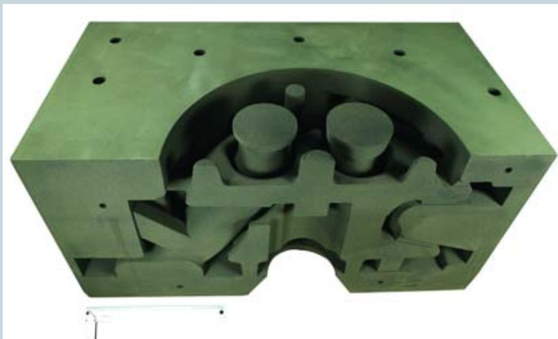
Bild 3: Formhälfte der Voxeljet-Gussform
