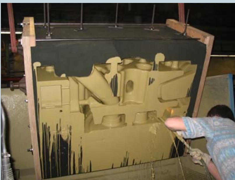
Bild 4: Schlichtebehandlung der Voxeljet-Form
